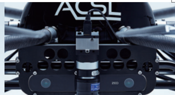
前方障害物との距離制御用ステレオカメラ
