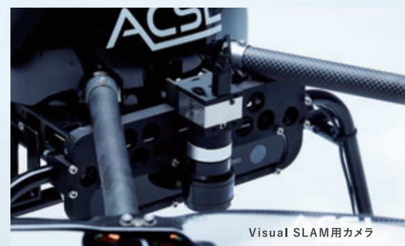
前方障害物との距離制御用ステレオカメラ
